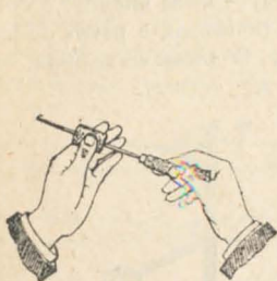
Fig. 16.—Cómo perfora un tapón de corcho.
