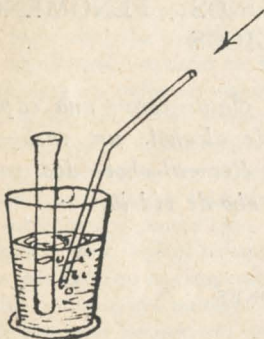
Fig. 38. — La corriente de aire acelera la evaporación del éter.
