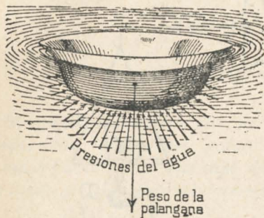
Fig. 25.—Las presiones del líquido constituyen el empuje , que obra hacia arriba. El peso del cuerpo obra hacia abajo. Como estas dos fuerzas son iguales resulta así el equilibrio.
