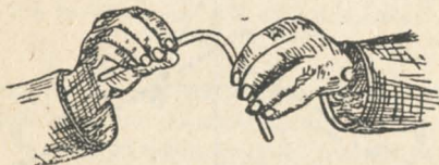
Fig. 8.—Modo de doblar un tubo de vidrio.
