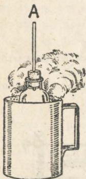
Fig. 34.—Dilatación de un líquido.
