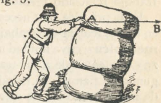
Fig. 3.—A es el punto de aplicación de la fuerza; AB indica la dirección y valor de la fuerza; la flecha indica su sentido.
