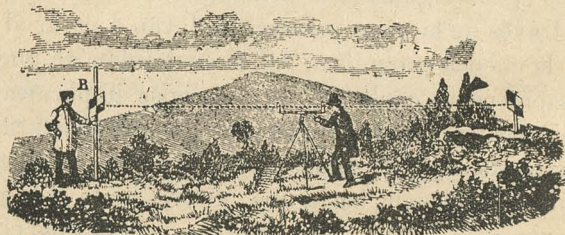
Fig. 31.—Uso del nivel de agua
