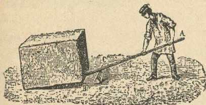
Fig. 12.—La palanca de primer género.
